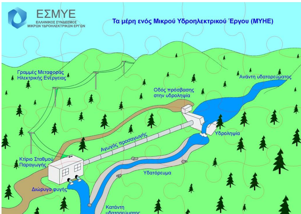
Το παλζ με τα μέρη ενός Μικρού Υδροηλεκτρικού Έργου (ΜΥΗΕ)
